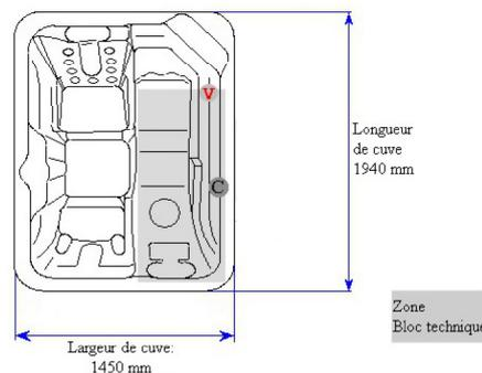
⊙ = Zone câble alimentation électrique (faire arriver le câble en dehors de la zone du bloc technique prévoir 2 mètres)      ▼ = Zone de vidange diamètre 40 mm
