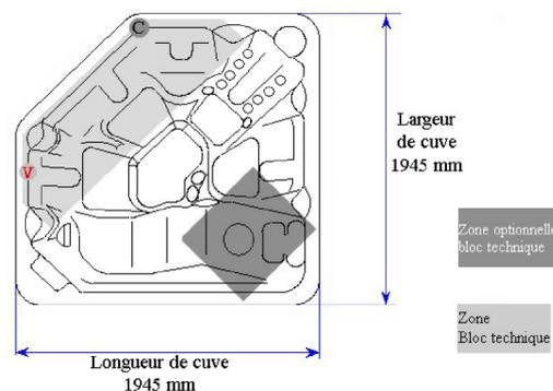
= Zone câble alimentation électrique (faire arriver le câble en dehors de la zone du bloc technique prévoir 2 mètres) = Zone de vidange diamètre 40 mm
