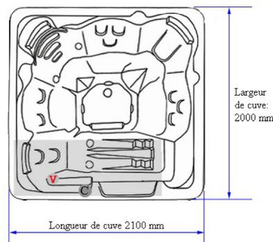
= Zone câble alimentation électrique (faire arriver le câble en dehors de la zone du bloc technique prévoir 2 mètres) = Zone de vidange diamètre 40 mm
